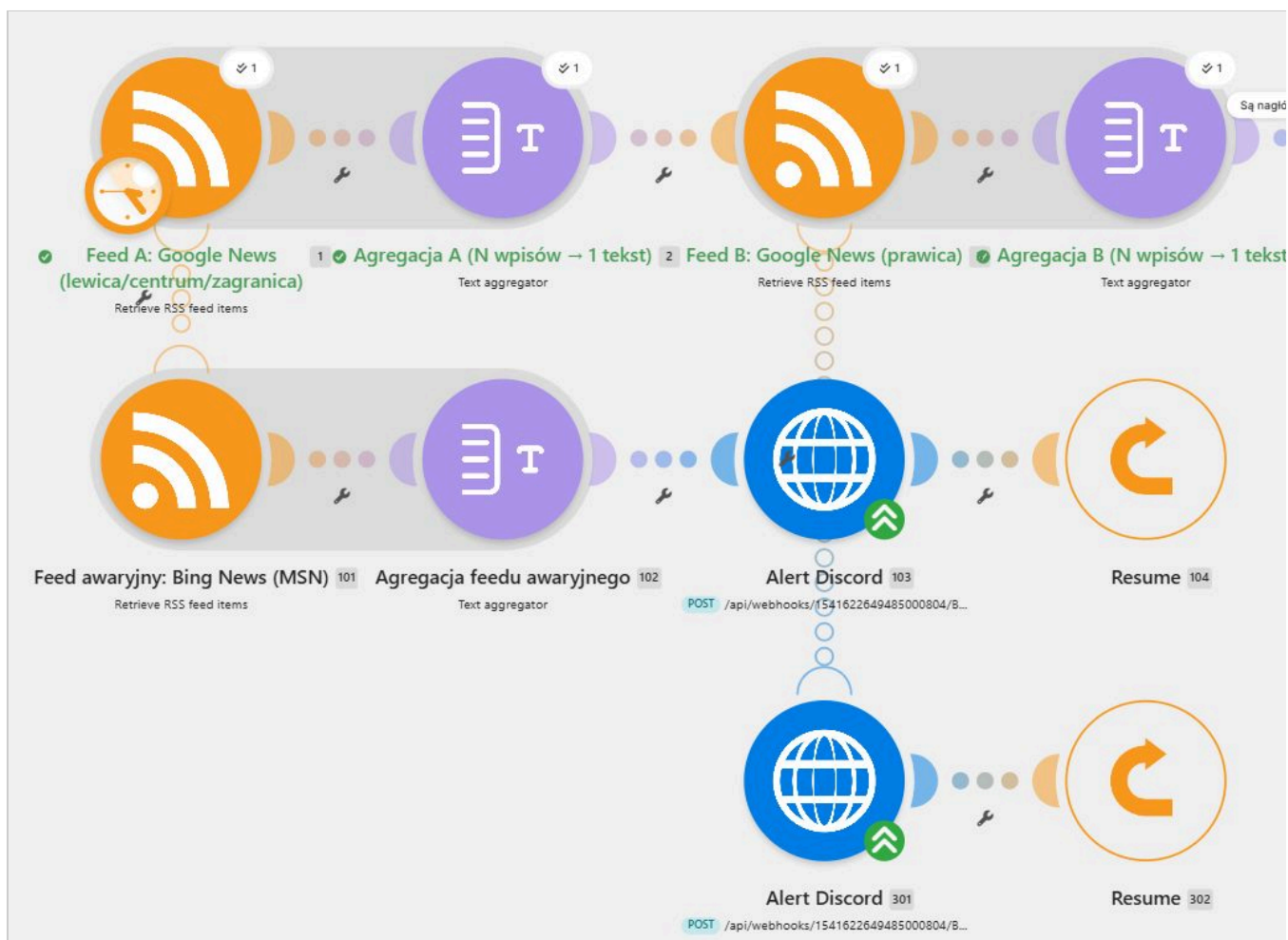
Rys. 3. Ścieżka błędu feedu A. Gdy Google News nie odpowiada, moduł RSS Bing News (odpowiednik MSN) dostarcza nagłówki zastępcze, wysyłany jest alert na Discorda, a dyrektywa Resume podstawia zebrany tekst jako wynik modułu 1 — przebieg trwa dalej.
